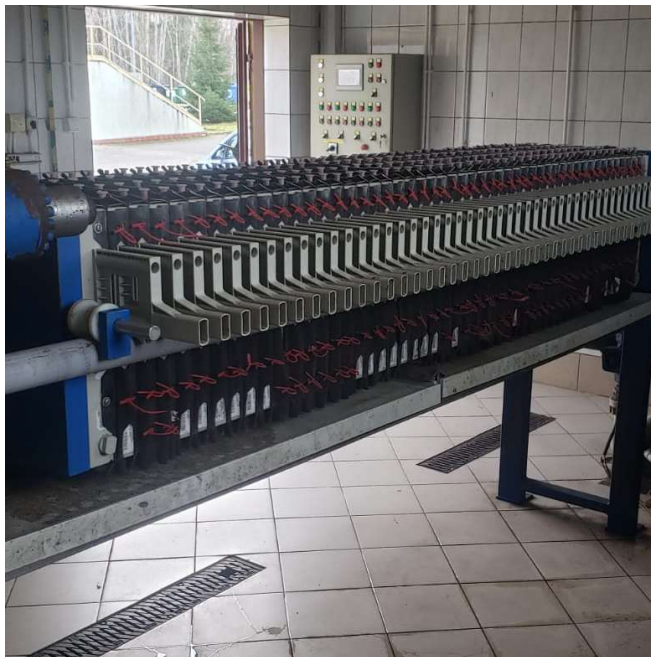
Fot. 15. Prasa odwadniająca do osadu
